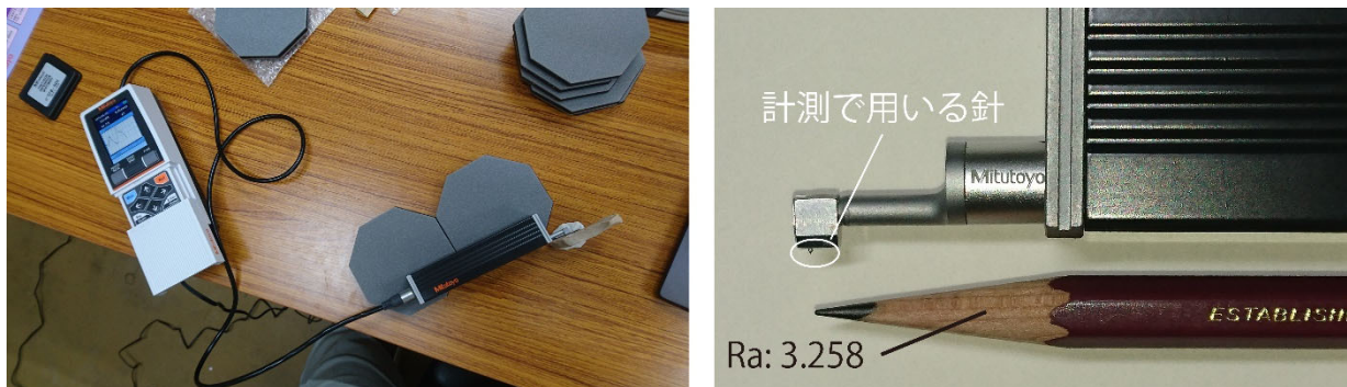
図2 表面粗さの計測の様子（左）。微小な針で引掻くことで表面粗さを計測する（右）。
